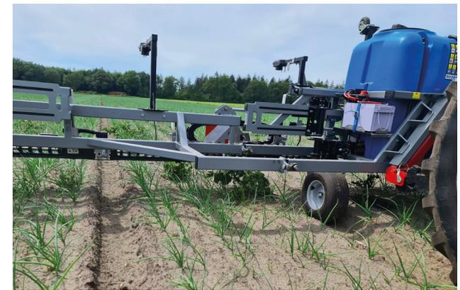
Die RXF900 ist eine Anbauspritze, welche am Frontkraftheber des Traktors aufgenommen wird. Durch sechs horizontal ausgerichtete Kameras wird der Pflanzenbestand während der Fahrt erfasst.
