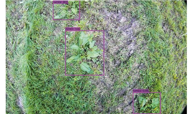
Wird eine Pflanze während der Fahrt erkannt, öffnen sich beim Erreichen des Spritzbalkens die benötigten Spritzdüsen um die Ampferpflanze vollständig mit Pflanzenschutzmittel zu benetzen. Dieser Vorgang funktioniert bei Kurvenfahrten sowie variierenden Fahrgeschwindigkeiten.
